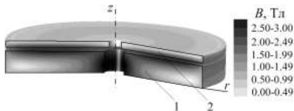
Рис.1 – Распределение индукции: 1 – индуктор ИДД; 2 – якорь ИДД.
